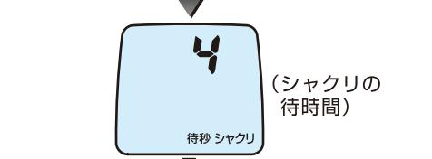
5. PICKUPスイッチを押してパワーレバーで速度を設定すると、シャクリがスタートします。
