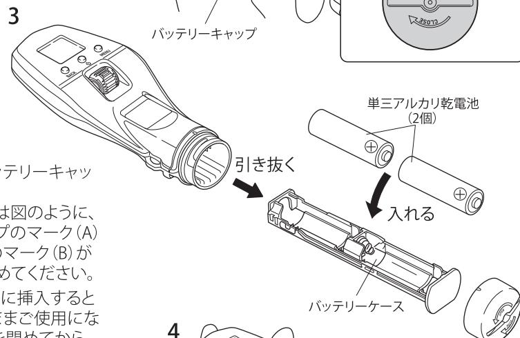
4. バッテリーケースを本体に戻し、バッテリーキャップを右に回して取り付けます。
