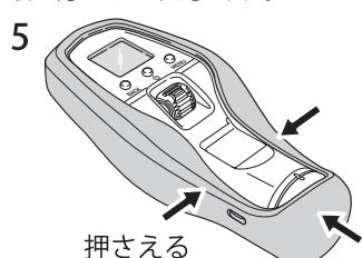
※右図のようにめくれやストラップホルダーがカバーに納まっていないと電池のトラブルになります。必ず左図のようにしっかりと押さえ、確実にカバーに本体を納めてください。
