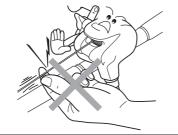
●船上でコードの再接続をするときは、接続部に海水などの水分が付着していることがありますので、乾いた布でよく拭き取ってから、接続してください。
