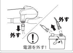
●使用状況や保管状況によって、コードが断線、ショートなどの故障を起こし、発煙・発火に至る場合があります。『コード取り扱い上のご注意』、『コードのお手入れのしかた』、『その他お手入れ上のご注意』を必ずお守りください。なお、コードの手入れは、電源を外してから行ってください。古いコードは断線、ショート等故障の原因となりますので、リールの性能を維持するためにも、2年ないし使用60回での交換をおすすめ致します。
