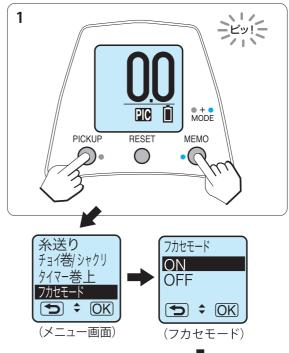
3.ジョグパワーレバーでアタリアラームの設定 のON/OFFを選択し OK (MEMO スイッチ) を押します。
