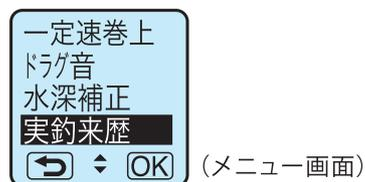
3. 総巻上距離と総使用時間が確認できます。OK (MEMO スイッチ) を押すと水深画面に戻ります。
