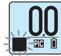
3. ジョグパワーレバーを操作し、キープしたい巻上速度になるよう調節し、ジョグパワーレバーから指を離してください。しばらくすると自動制御が始まり、調節した速度をキープします。
