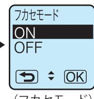
3. ジョグパワーレバーでアタリアラームの設定のON/OFFを選択し **OK** (**MEMO** スイッチ) を押します。
