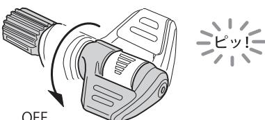
14.テンションを調整して、ジョグパワーレバーをMAXの位置まで倒し、糸色に注意しながら最後まで道糸を巻いてください。
