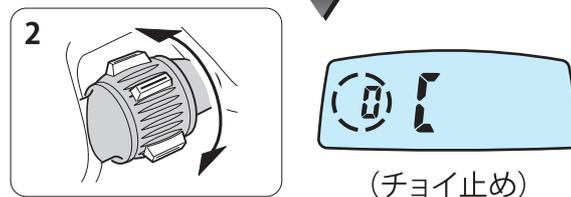
3. PICKUP (チョイ止巻) スイッチ を押して水深画面に戻せばセット完了です。
