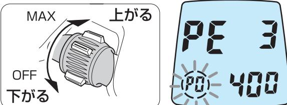
※図の場合ではPE3号400mのデータがセットされます。
