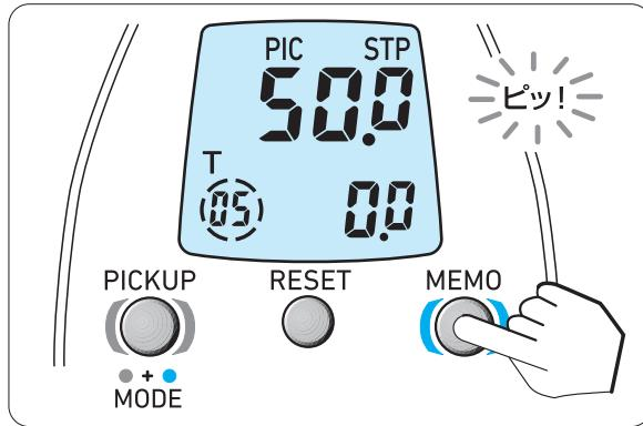
1. **MEMO** (底から/棚メモ) スイッチと **PICKUP** (チョイ止・巻/シャクリ) スイッチを同時に2秒間押してモード画面にしてから、さらに **PICKUP** (チョイ止・巻/シャクリ) スイッチを押し、コマセタイマー巻上げ設定画面にします。
