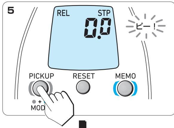
6. **PICKUP (チョイ止・巻/シャクリ)** スイッチを押してジョグパワーレバーで速度を設定すると、シャクリがスタートします。
