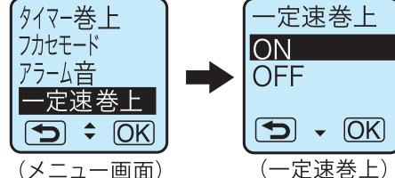
3. ジョグパワーレバーを操作し、キープしたい巻上速度になるよう調節し、ジョグパワーレバーから指を離してください。しばらくすると自動制御が始まり、調節した速度をキープします。
