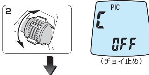
3. PICK UP（チョイ止・巻/シャクリ）スイッチを押して水深画面に戻せばセット完了です。
