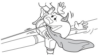
●水気を含んだ糸を強い張力で巻いた状態でリールを保管しないでください。保管時に糸が乾燥すると縮み、スプールを破損する恐れがあります。特に、PE専用機種には、ナイロン・フロロラインなどを巻かないでください。
