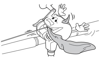
●水気を含んだ糸を強い張力で巻いた状態でリールを保管しないでください。保管時に糸が乾燥すると縮み、スプールを破損する恐れがあります。特に、PE専用機種には、ナイロン・フロロラインなどを巻かないでください。
