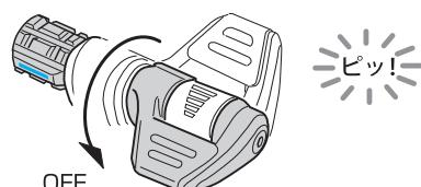
13.テンションを調整して、ジョグパワーレバーをMAXの位置まで倒し、糸色に注意しながら最後まで道糸を巻いてください。
