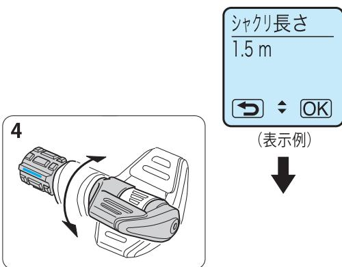
5. ジョグパワーレバーでシャクリ間隔を設定し、OK (MEMOスイッチ) を押します。
