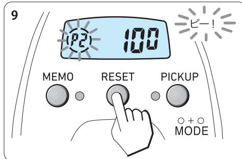
11. **RESET(リセット)スイッチ**を2秒以上押して表示**0.0**の点滅が終われば完了です。
