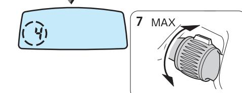
7.テンションを調整して、ジョグパワーレバーをMAXの位置まで倒し道糸を巻きます。
