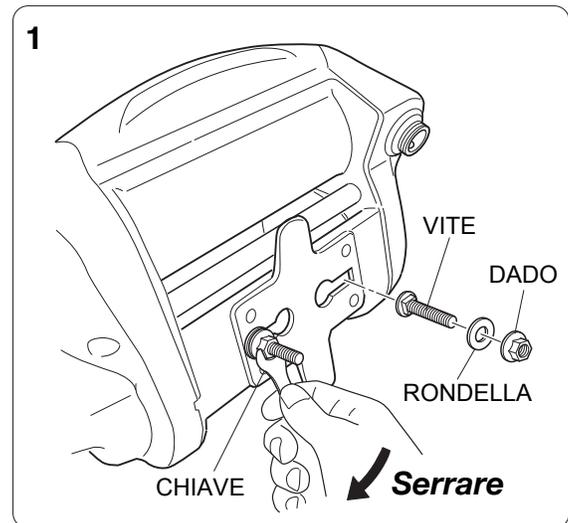
2) Inserire la staffa e fissare saldamente i dadi.
