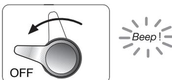
11. Dopo aver bobinato quasi completamente il filo, premere il pulsante **RESET** per più di 2 secondi. Con il suono d'allarme, appare l'indicazione **0.0** e l'impostazione è terminata.
