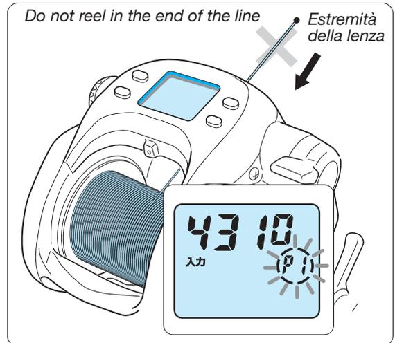
6) Dopo aver bobinato il filo quasi completamente, premere il pulsante **RESET** per più di 2 secondi sino a che sul display apparirà il valore "500". (500 è l'indicazione prememorizzata. Una volta si cambia in un altro metodo dell'impostazione, il valore può essere differente.)
