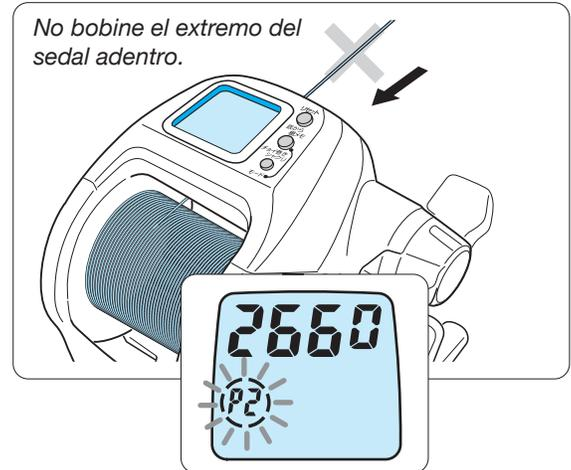
10. Pulse el **CONMUTADOR DE RESETEO** durante 2 segundos, hasta que la pantalla muestra **300**. (300 es el valor predeterminado)
