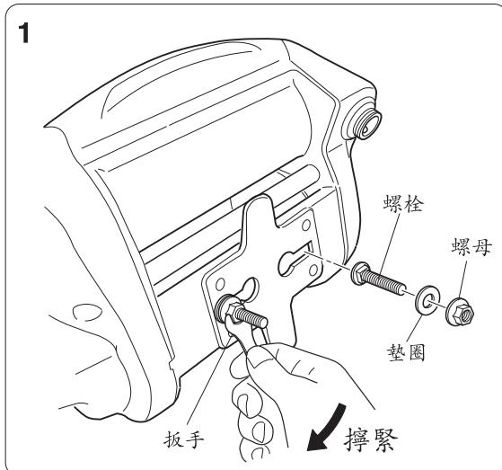
2. 連接卡箍時，將魚竿固定到位。擰緊魚竿卡箍螺母以固定。要用魚竿卡箍固定捲線器，將螺釘固定在捲線器的腳上，然後將杆放在螺紋之間，再添加卡箍並擰緊螺母。
