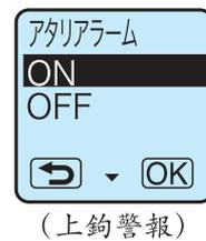
如果檢測到比設定的靈敏度更快的運動，上鉤警報鳴響，用聲音發出上鉤通知，因此在視線離開時也可透過聲音知道上鉤。
