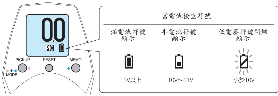
※捲線器的檢測電壓與實際的電源電壓多少有些誤差。
