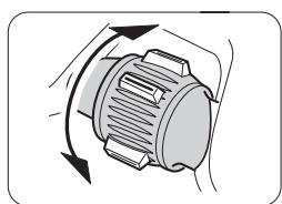
※操作JOG動力控制桿，選擇項目反色顯示。
