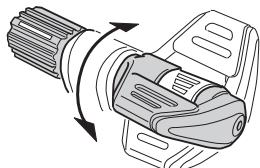
※操作JOG動力控制桿，選擇項目反色顯示。
