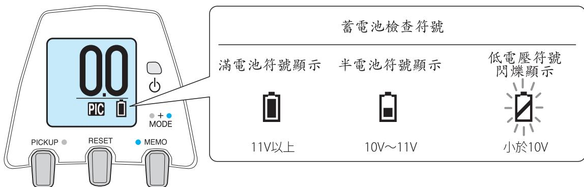
※捲線器的檢測電壓與實際的電源電壓多少有些誤差。
