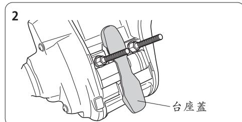
3. 將卷線器設置到杆上，從杆的下面把杆夾持器頂到杆上將杆夾緊。用硬幣等將螺母擰緊固定。
