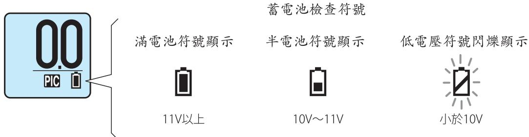
※捲線器的檢測電壓與實際的電源電壓多少有些誤差。
