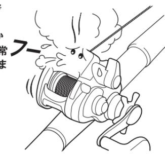
●船上でコードの再接続をするときは、接続部に海水などの水分が付着していることがありますので、乾いた布でよく拭き取ってから、接続してください。そのまま接続すると、ショートして、感電・発煙・発火の恐れがあります。
