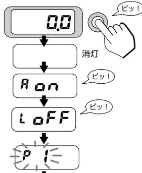
2 スイッチを2回押して、[P3] (引出し入力) 画面にしてください。[P3] と [50] が交互に点滅し、引出し入力画面になります。
