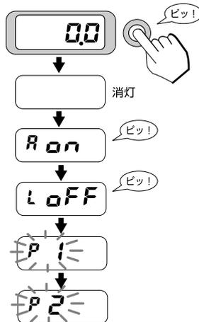
5 スイッチを1回押して [P2] (下巻き入力画面) にしてください。[P2] が点滅します。(上糸が100mの場合は7へ)
