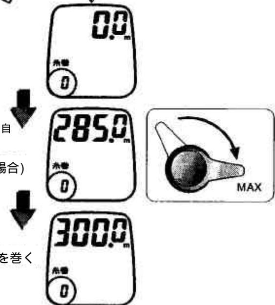
レバーを1度OFFの位置まで戻し(アラーム音)、再度レバーを、MAXまで倒して(アラーム音)、残りの糸を巻いてください。
