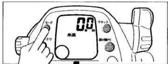
「糸巻」画面になったら、パワーレバーをMAXの位置まで倒して道糸を巻きます。
