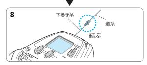
9.テンションを調整して、ジョグパワーレバーを MAXの位置まで倒し、糸色に注意しながら残 り100mになるまで道糸を巻きます。
