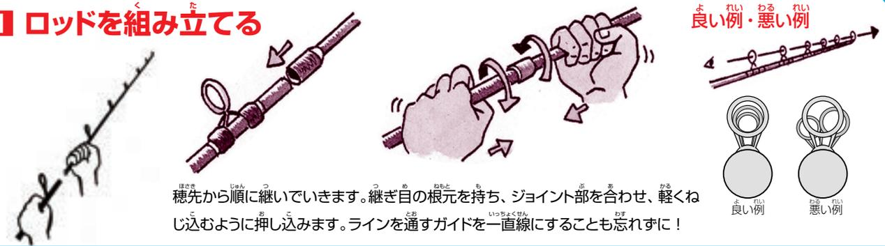
穂先から順に継いでいきます。継ぎ目の根元を持ち、ジョイント部を合わせ、軽くねじ込むように押し込みます。ラインを通すガイドを一直線にすることも忘れずに!
