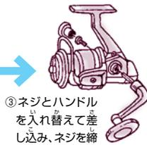
③ネジとハンドルを入れ替えて差し込み、ネジを締め、キャップを付けて完了です。
