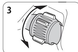
3. ジョグパワーレバーを操作し、キープしたい巻上速度になるよう調節し、ジョグパワーレバーから指を離してください。しばらくすると自動制御が始まり、調節した速度をキープします。
