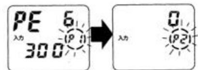
指定入力画面になりますので、もう1度 **リセット** と **底から / 柵メモ** スwitchを同時に押し続けてください。[ **P2** ] が点滅]
