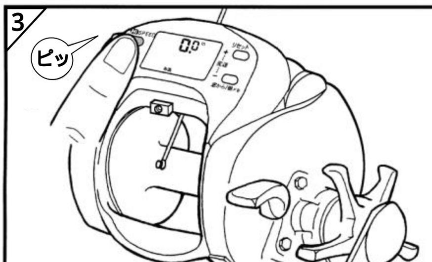
**Hi SPEED** スイッチか **自動巻き** スイッチを押して道糸を最後まで巻きます。
