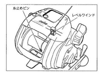
通電してから、パワーレバーをMAXの 位置まで倒して道糸を巻きます。
