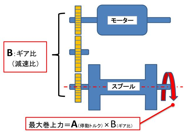
最大巻上力とは、停動トルクにスプールまでのギア比(減速比)を掛けあわせたスプール軸上の最大トルク値です。(スプール軸から半径1cmの位置での巻上力)
