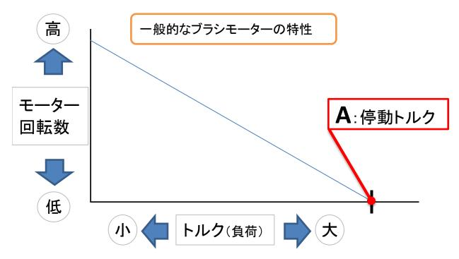
回転しているモーター軸を ロックさせた時の力を「停動トルク」と呼びます。 (モーターの瞬間的な最大出力値です)
